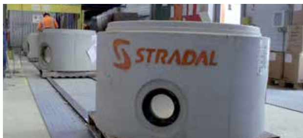
Ligne de finition et de contrôles des fonds Stradifond.
