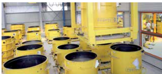
24 h de séchage pour les fonds en démoulage différé Stradifond.
