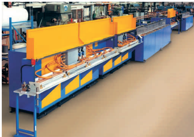
▲ Технологическая линия закалки и отпуска проволоки
