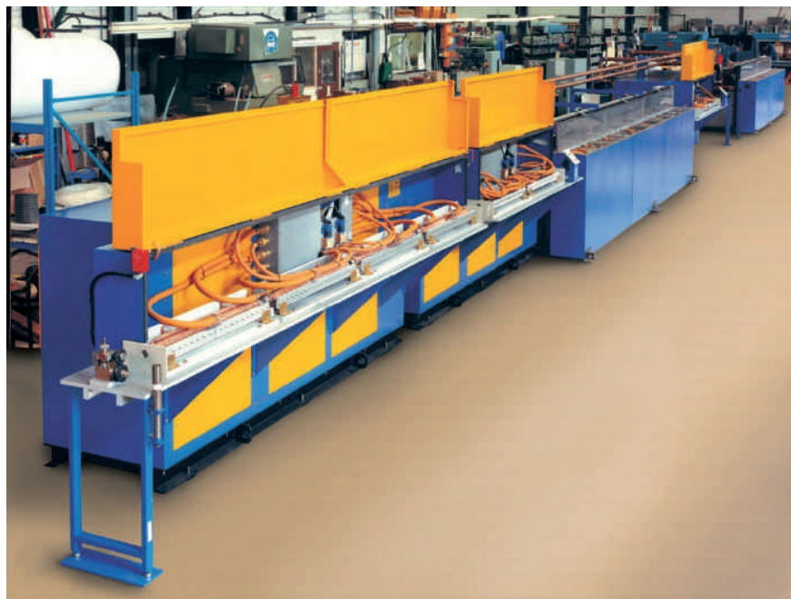
▼ Bild 1. Drahtanlage mit Härte- und Vergütungsverfahren
