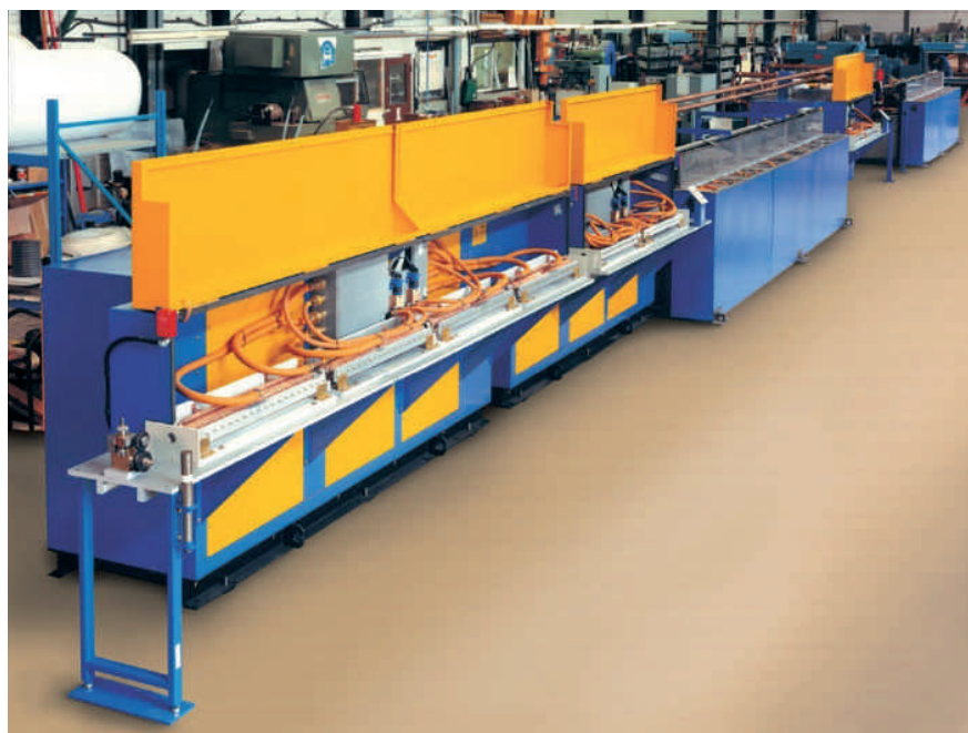
▼ Figura 1. Línea de proceso de temple y revenido de alambre
