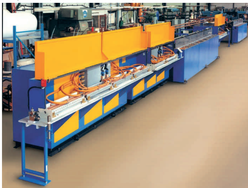
▼ Figura 1. Linea di processo di indurimento e rinvenimento per fili
