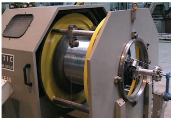
▲ Машина TEC 630-SWA производства группы компаний «Портье – Годер груп»
