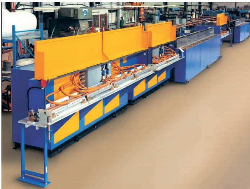
▼ Figure 1. Ligne de processus de trempe et revenu pour fil
