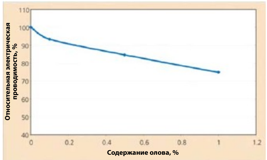
▲ Рис. 2. Влияние содержания олова на удельную электропроводность CuFe2P
