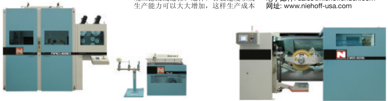
○ 数据电缆绞线生产线由一个退扭放线装置ARD 630 D (左)，纵型放带装置ALB 600以及双捻绞线机DSI 631 (右)
