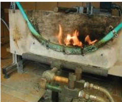
图片2: 根据IEC 60331-25标准设计的耐火试验
