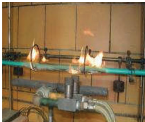
图片3: 根据EN 50200标准设计的耐火试验
