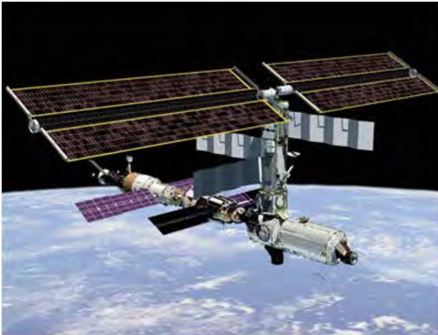
« איור 2. מערכת תאי השמש של תחנת החלל הבינ לאומית ISS
