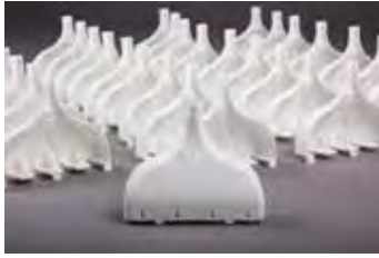
« איור 1. 200 חלקים בשנה, עבור חברה GI View. טכנולוגיות SLS כמוצר סופי, ללא צורך בשינוי תכן בחלק והתאמה לייצור בהזרקה וחסכון בזמן ועלויות של ייצור התבניות (דגם התכנות הפך להיות המוצר הסופי)
