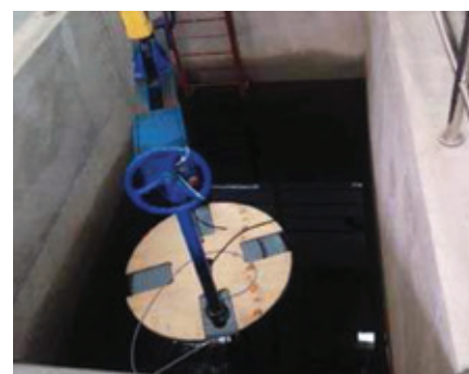
▲ Figura 1: Microconducto con cable sumergido en agua
