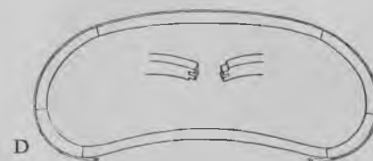
Fig. 1832. A: Spændemetode ved sløjfede samlinger. B: Sådan spændes en svejftet stolearm. C: Spændemetode ved sløjfede samlinger. D: En sofaramme af denne form sammenspændes med et jernbånd, der hægtes på bænkdupperne.
