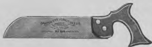
Fig. 1538. Krydsfinérsav. Fabrikat »Sandviken«. Med fine tænder. Særlig anvendelig til udskæring af krydsfinér og isoleringsplader. Længde 11" - 15". Antal tænder pr. tom.: 13 - 10. (CFP).
