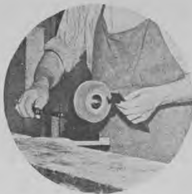
Fig. 1851. Det her viste slibeapparat burde være bandlyst til slibning af snedkerværktøj. Stenen er alt for lille i tværmål, hvorved jernets fas slibes for meget hul, og endvidere er det vanskeligt, selv om apparatet er forsynet med anlæg, at slibe tilstrækkeligt jævnt, når man skal styre jernet med den ene hånd, medens man med den anden drejer stenen rundt.
