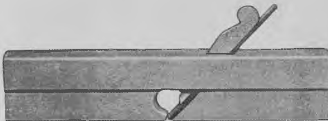
Fig. 1568. Simshøvl. Hvidbøg. Til nedlægning af beslag. Med enkelt jern. Bredde af jern 10 - 15 - 20 mm. Fabrikat J. P. Bendixen. (CFP).
