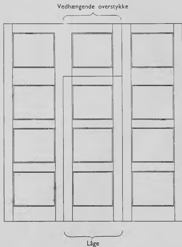
Fig. 945. Port med vedhængende overstykke og låge.
