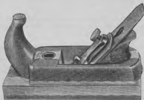
Fig. 1560. Reform-pudshøvl. Luksusudførelse. Frugttræ og hvidbøg med pockenholtsål. Stilbar spuns. Jernkile med stilleskrue. Med tyndt, dobbelt jern. Bredde af jern 48 – 51 mm. Fabrikat J. P. Bendixen. (CFP).
