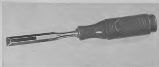
Fig. 1590. Stemmejern med plastichefte. Disse hæfter er meget holdbare – det stærkeste, der endnu har været fremme – de kan tåle, at man slår på dem både med knippel og med hammer, uden at flække. Når hæftet skal påsættes stemmejern, opvarmes det til ca. 70^{\circ} , og efter afkølingen sidder det fuldkommen fast. Aftagningen af hæftet foregår på samme måde ved opvarmning til 70^{\circ} . (Det foregår nemmest i vand). (CFP).
