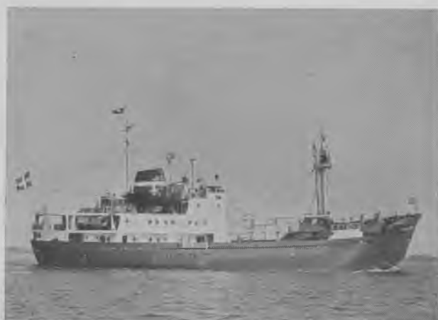
Fig. 1510. Generalarrangement af M/S »MAGGA DAN«, Rederiet Lauritzen, last- og passagerførende ishavsskib bygget 1956 på Ålborg Værft. Længde o. a. 245'0", bredde 45'0", fart 12 kn. Skibet, der kan medføre 33 passagerer, er specielt forstærket og udstyret for sejlads i isfyldt farvand. Maskinrummet er placeret agter og oven over dette er beboelsen for besætning og passagerer samlet i poop'en med styrehuset opbygget på forkant. Beboelsen er fordelt med mandskabet på mellemdækket, maskinofficerer, assistenter og kabys på hoveddækket, passagerer på promenadedækket og navigationsofficerer på båddækket. Udkigstønden i forreste mast er i princippet beskrevet under fig. 1502. Adgangen til denne sker gennem den svære, selvstagede mast.
