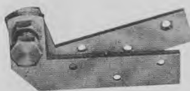
Fig. 1039. Svingrammebeslag. a: Foroven. b: Forneden. Skruen på beslaget til understykket er stilbar, rammen kan derved hæves og sænkes. (Carl Rasmussen).
