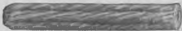
Fig. 1618. Rawplug holdere. Til omskiftelig bor nr. 6 - 8 - 10 - 12 - 16 - 18. Omskiftelige bor, trekantede nr. 6 - 8 - 10 - 12 - 16 - 18. Almindelige bor nr. 14 - 20.
