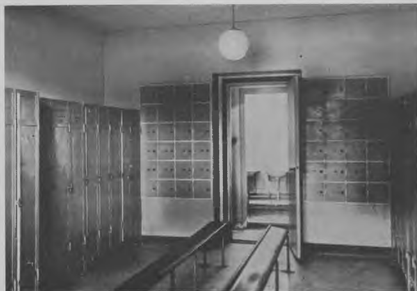
Fig. 791. Bemærk bænkene og de gode pladsforhold. I bagvæggen er indbygget små madskabe, som — for at undgå trængsel — kan åbnes både til gang og garderobe. (Arbejdstilsynet).
