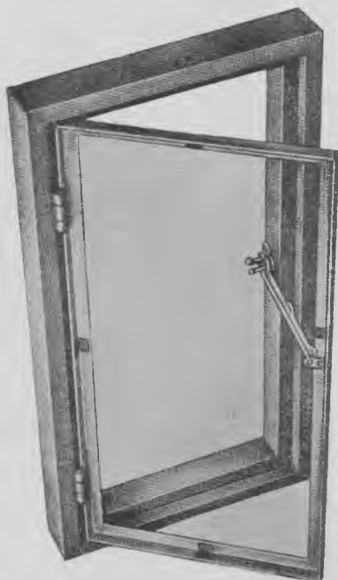
Fig. 1019. Sidehængt ventilationsramme, beslæet med blad-hængsler og udskyderstang. (Carl Rasmussen.)
