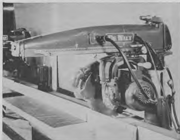
Fig. 1382. »De Walt« universalmaskine. (Opstillet til afkortning).
