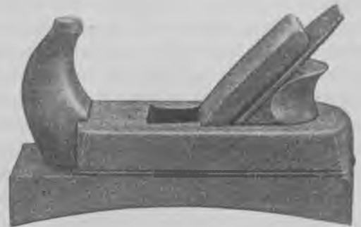
Fig. 1576. Skibshøv. Rødbøg. Med dobbelt jern. Bredde af jern 51 mm. Fabrikat J. P. Bendixen. (CFP).
