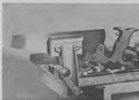
Fig. 1863 e. »Hobelfix« som fileklo. Takket være den frie arm kan enhver størrelse sav fastspændes.
