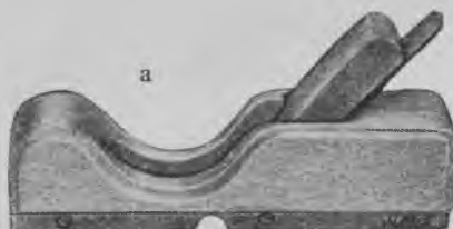
Fig. 1568. Simshøvl. Hvidbøg. Til nedlægning af beslag. Med enkelt jern. Bredde af jern 10 - 15 - 20 mm. Fabrikat J. P. Bendixen. (CFP).
