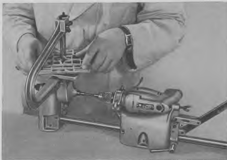
Fig. 1738. Metabo-boremaskine, som drivkraft ved deкупørskæring.
