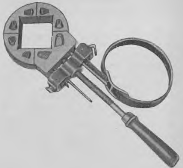
Fig. 1829. Denne limtvinge er en nyhed, der ganske sikkert snart vil spredes rundt på værksteder, hvor man ved hjælp af denne snilde opfindelse vil være i stand til i en håndevending at klare, hvad der før kunne være et ret indviklet problem.
