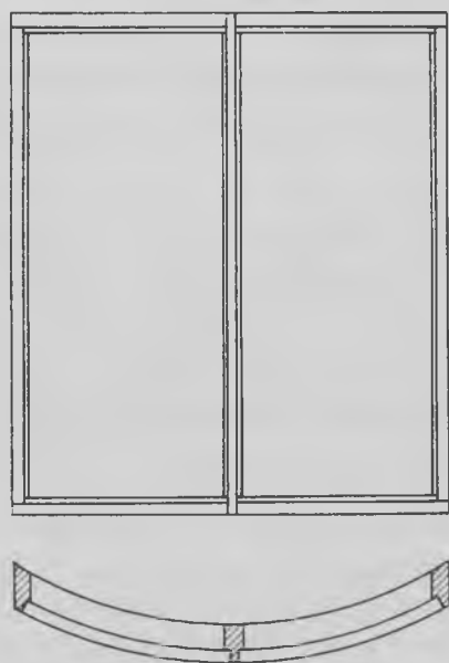
Fig. 870. Planbuet karm med siderne i vinkel på buens diameter.
