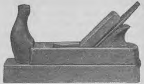
Fig. 1555. Skrubhøv. Rødbøg, hvidbøg. Med enkelt jern. Bredde af jern 30 - 33 - 36 mm. Fabrikat J. P. Bendixen. (CFP).
