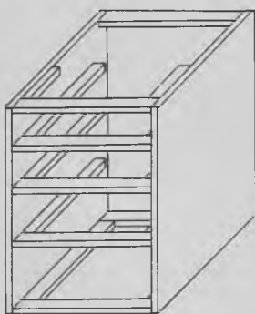
Fig. 982. Skuffeskab med påskruede løbelister. Er siderne ikke afspærrede, må de to bageste skrøer have svindhuller.
