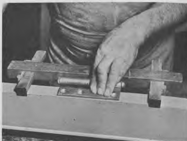
Fig. 990. Opmærkning af hamborghængsler, hvor ryggen af hængslet og lappen ikke er parallelle. Ved denne opmærkning er man sikker på, at hængselryggen bliver parallel med dørens flade.
