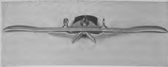
Fig. 1578. Bugthøvler med stilbar land. Denne bugthøvler er forsynet med to land under sålen, der indstilles ved hjælp af de to fingerskruer. Den anvendes til affasning af kanter. Landene skulle bevirke, at affasningen bliver mere ensartet. (CFP).
