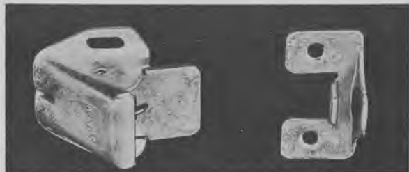
Fig. 1224. »Kungslåsen«, ny skablås, der ikke kræver ud- stemning i dør eller forramme, låsen skrues på indersiden af døren og slutblikket på kanten af falsrammen, den er meget robust og trækker døren godt til; men giver et smæld, når den lukkes. (CFP).
