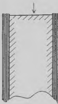
Fig. 1108. Dørkant af dør leveret til beslåning uden ren-skæring efter pålimningen af krydsfinér.
