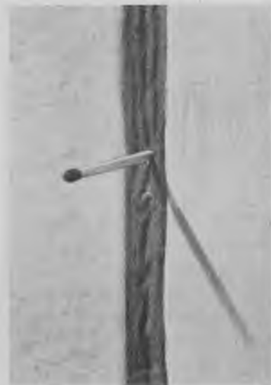
Fig. 1289. Secomastic efter 10 års anvendelse. Der er ingen tegn på revner eller brud, og mastic'en er stadig så plastisk, at en tændstik kan sættes ind i den. Læg mærke til den rynkede overflade, som viser, at fugen har været udsat for betydelige udvidelser og sammentrækninger.
