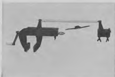
Fig. 1863 c. »Hobelfix« til bearbejdning af rundstokke.
