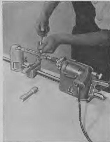
Fig. 1737. Metabo-boremaskine som drivkraft ved drejebænk. Man kan dreje træ på en længde af indtil 280 mm.
