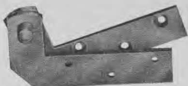
Fig. 1039. Svingrammebeslag. a: Foroven. b: Forneden. Skruen på beslaget til understykket er stilbar, rammen kan derved hæves og sænkes. (Carl Rasmussen).
