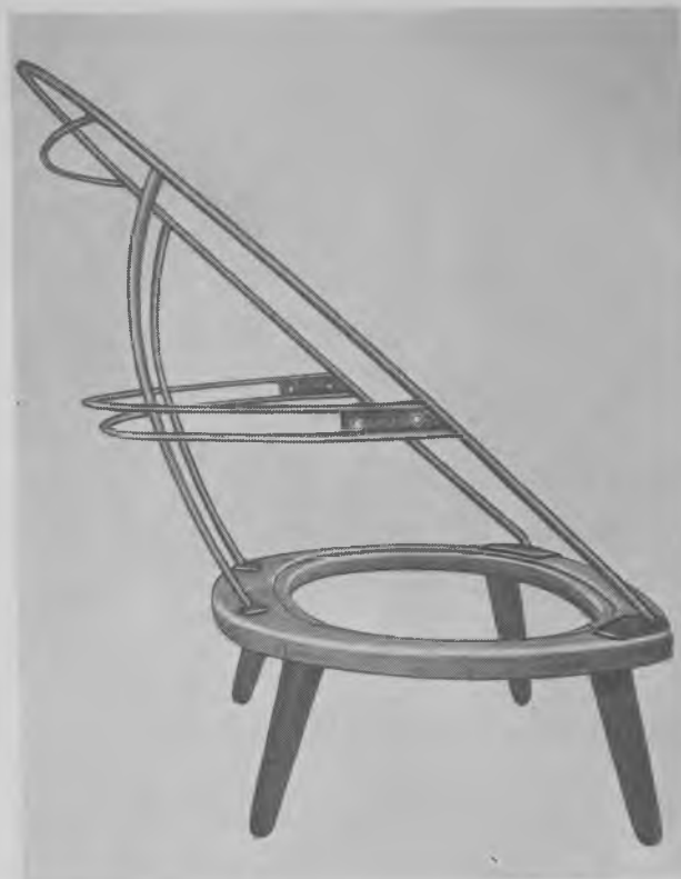
Fig. 686. Stålstellet har fået sin renæssance. Ved påsyning af lærred har man et godt grundlag for skummaterialerne. Opspændt krydsfinér er også brugbart, men skummaterialernes blødhedsgrad bliver ikke godt udnyttet på den hårde bund.
