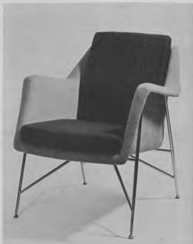
Fig. 1518. I passageravertingen i M/S »PRINSESSE MARGRETHE« er der anvendt to stoletyper, en armstol og en salonstol. Begge typer er udført af et rustfrit stålørstativ, der bærer ryg og sæde udformet som en skal af glasfiberarmeret polyester. Skallerne står dels glatte i eget materiale og dels betrukket med uldent stof. Sæde- og rygpuder er udført af skumgummi og betrukket med uldent stof.
