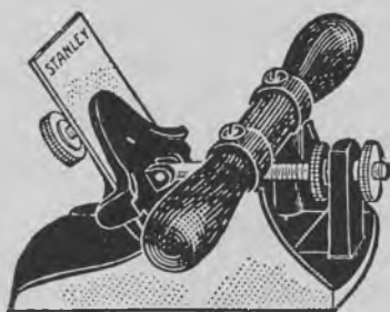
Fig. 1588. Ziehklingehøvl. Med stilleskrue for jern. Til finérhøvlen kan leveres løse jern samt tandhøvljern. Længde af høvl 6\frac{1}{4} tom. Bredde af jern 3 tom. (CFP).
