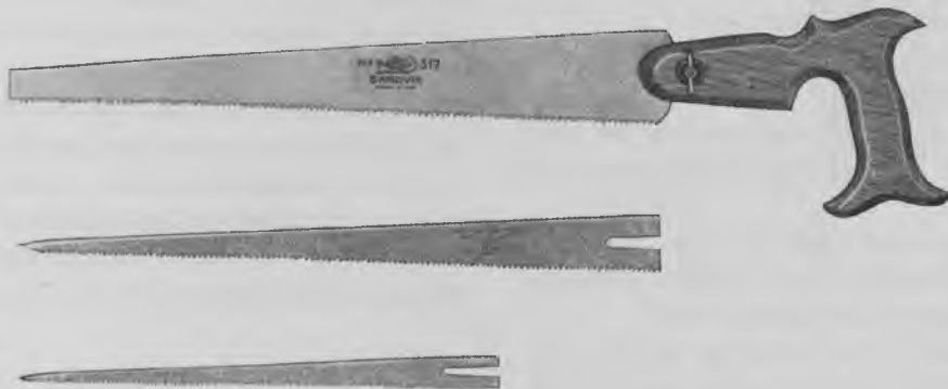
Fig. 1537. Stiksav. Fabrikat »Sandviken«. Med 3 løse klinger. Klingernes længde: 10 - 14 - 16 tom. (CFP).
