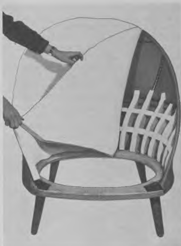
Fig. 690. Her vises påsætning af pladen, der danner en jævn og lækker overflade.
