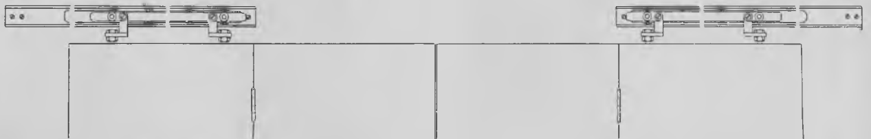
Fig. 1176. »Perkeo« skydedørbeslag, type 15 (skema, se fig. 1173).
