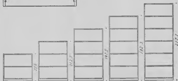
Fig. 767. Reoler til brevordnere i kvartformat. Størrelse på brevordnere 30,5×28×8,5 cm.
