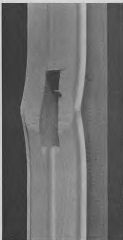
Fig. 919. Hulstykke, hvor der forekommer efterstikning i stedet for skævt bryst.
