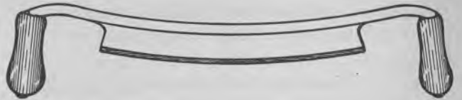
Fig. 1709. Båndkniv. Polerede hefter. \frac{1}{4} stål. Længde af skær 9 - 10 tom. Bredde af skær 35 mm. (CFP).
