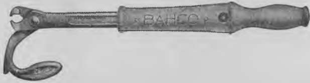
Fig. 1693. Sømudtrækker. Fabrikat »Bahco«. (CFP).
