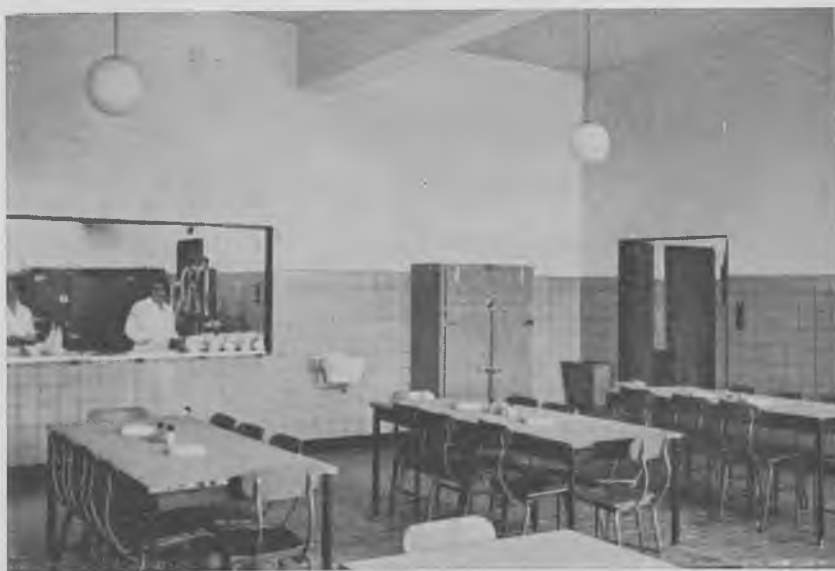
Fig. 795. Velindrettet spisestue med marketenderi. Bemærk: Klinker på gulvet og fliser på væggene, god belysning, stålmøbler. Papirkasse på væggen og drikkevandsfontæne. I køleskabet kan arbejderne få opbevaret deres mad, når den medbringes i nummereret blikæske. (Arbejdstilsynet).
