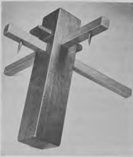
Fig. 841. Stregemål til karmtræ. Den brede kile for oven kiler begge stregemålets pinde på en gang. Kilen skal sidde på tværs af den øverste pind, sættes den på langs af pinden vanskeliggøres indstillingen.
