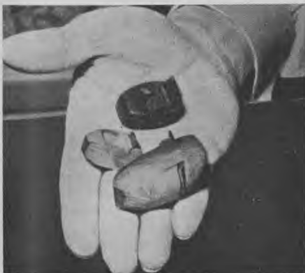
Fig. 1302. En hånd med 3 høvle. Dette værktøj er ikke kuriositeter, men nødvendige hjælpemidler for gelændersnedkeren, som laver dem selv til kehling af svingenes profiler.
