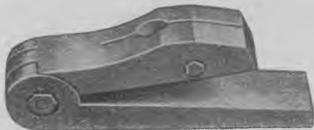
Fig. 1658. Andenæb. Hvidbøg. Med messingkruer. Med hul til blyant. Fabrikat J. P. Bendixen. (CFP).
