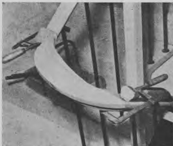
Fig. 1303. Det er vanskeligt at spænde et sving sammen, men læg mærke til hvor snedigt snedkeren har undladt at svejfe den sidste del af svinget ud for at få en god spændeflade. Den nederste tvinge spænder mod en skråtstillet vinduesstift, der bankes ind i svinget.
