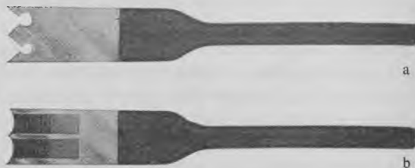
Fig. 1597. Hængselbeitel (Fabrikat E. A. Berg, Eskilstuna). a: (Lyremejsel) Bredden 26 mm. Tykkelse 1 - 1,25 - 1,5 - 1,75 - 2 mm. b: (Universal). Bredden 26 mm. Tykkelse 1,5 - 1,75 - 2 mm. (CFP).
