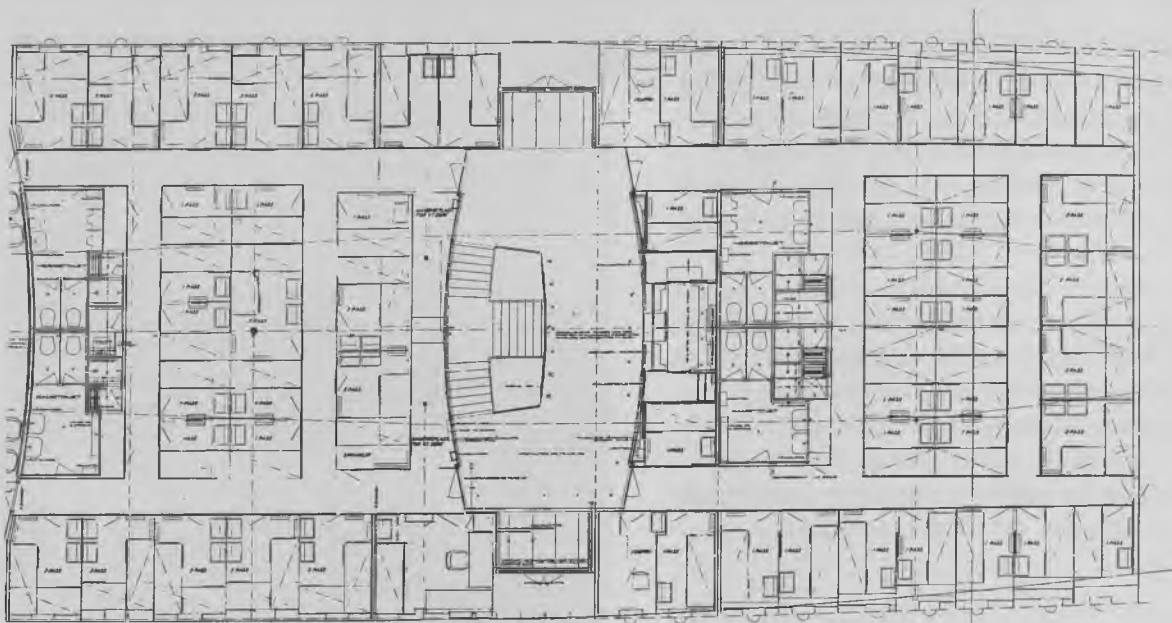
Fig. 1520. Apteringsstegning der viser 1. kl. kahytsafdeling på B-dækket i M/S »PRINSESSE MARGRETHE«. Hall'en i midten er gennem de to vindfang i borde landgangsforbindelse for passagerer på 1. kl.
