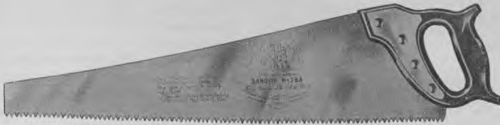
Fig. 1536. Håndsav. Fabrikat »Sandviken«. Krydsfilet. Højglanspoleret klinge. Ekstra tyndslebet mod ryggen. Plastic-håndtag med rustfri sidebeslag. Denne håndsav er den fornemste håndsav »Sandviken« fremstiller. Længde 26 tom. Antal tænder pr. tom. 6. (CFP).
