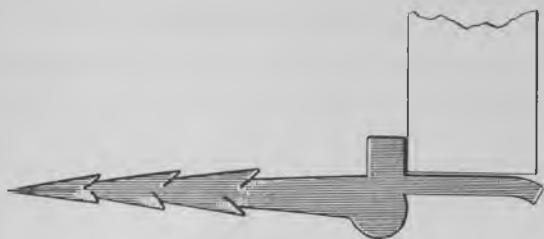
Fig. 1237. Bærejern til skoddedøre. Til mur. (CFP).
