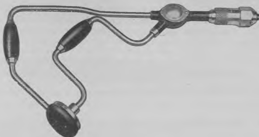
Fig. 1622. Hjørneborsving. Poleret. Med alligatorkæber. (CFP).
