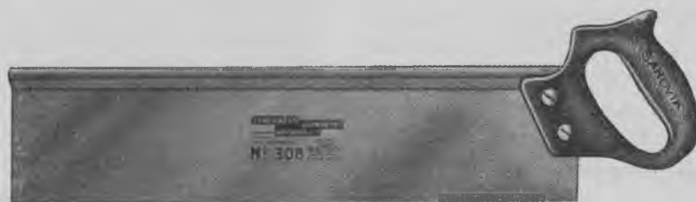
Fig. 1539. Rygsav. Fabrikat »Sandviken«. Længde 12 - 14 tom. Antal tænder pr. tom. 10. (CFP).
