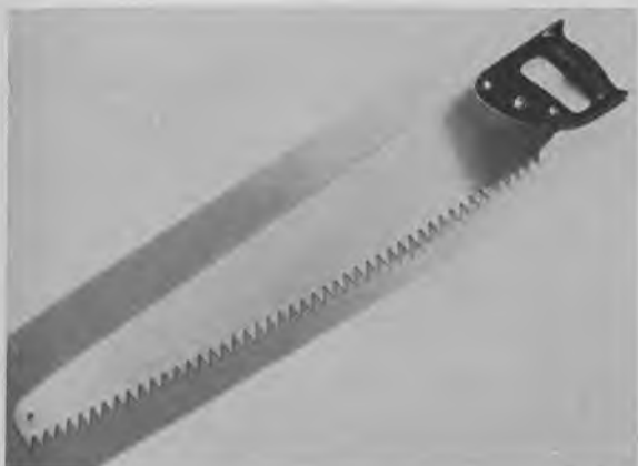
Fig. 1544. Gasbetonsav (Sandvik 257). Saven anvendes til skæring af gasbetonsten. Savens længde med håndtag er 840 mm. Klingens er hårdforkromet og kan ikke files med en fil, men skal slibes med en slibesten, herunder må man påse, at tandformen bibeholdes. (CFP).
