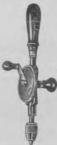
Fig. 1623. Håndboremaskine. Med 3-delt kæbe. Med enkelt keglehjul. For bor indtil 6 mm. Hele længden 310 mm. (CFP).
