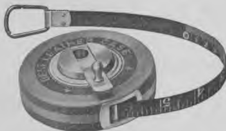
Fig. 1647. Båndmål i læderkapsel. Lærredsbånd med indvævet metaltråd. Bredde af bånd 16 mm. Dansk og meter. Længde 5 - 10 - 15 - 20 - 25 - 50 mtr. (CFP).
