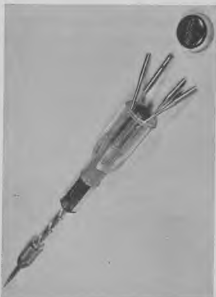
Fig. 1644. Spiralskruetrækker med gennemsigtig plastichefte, indeholdende tre forskellige bor og to skruetrækere. (CFP).
