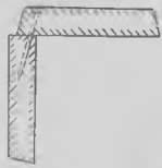
Fig. 1205. Sammensømmet hjørnebeklædningsliste. (Til beskyttelse af udadgående murhjørner.)
