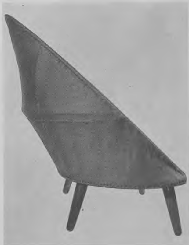
Fig. 687. Når lærred er påsyet jernstellet, kan polsteren klare resten ved hjælp af skæreinstrumenter og lim.
