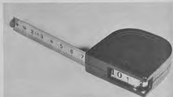
Fig. 1648. Ved måltagning af indvendige mål aflæses målet i udklinkningen ved pilene. (Carl Rasmussen).
