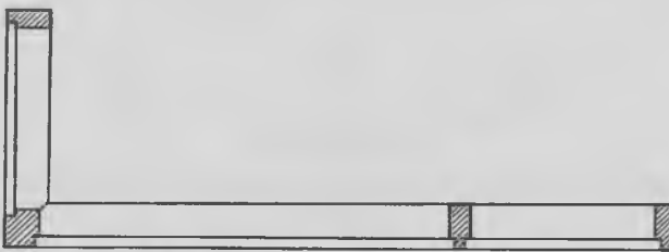
Fig. 873. Flerkantet karm til hjørnefacader.
