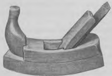
Fig. 1575. Skibshøv. Rødbøg. Med dobbelt jern. Bredde af jern 51 mm. Fabrikat J. P. Bendixen. (CFP).
