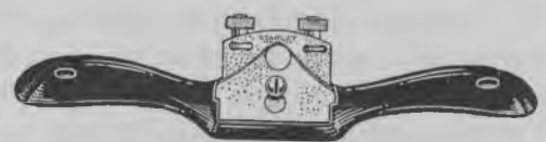
Fig. 1577. Bugthøv. Med lige sål. Med stilleskruer for jernet. Længde af høvl 10". Bredde af jern 2\frac{1}{8} ". (CFP).
