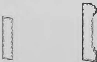
Fig. 1252. Almindelig glat fodpanel med hekling. Underkanten er smig for at slutte bedre til gulvet.
