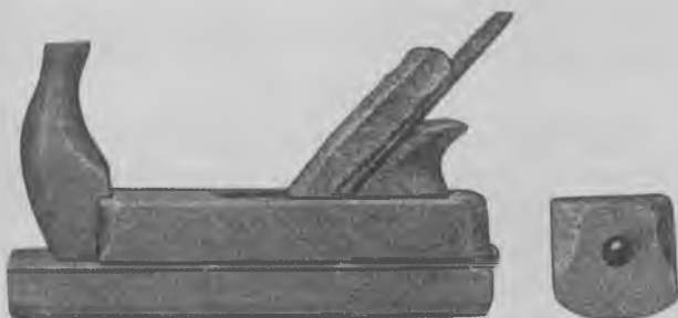
Fig. 1581. Hulkehøvler. Rødbøg. Med dobbelt jern. Bredde af jern 48 - 51 mm. Fabrikat J. P. Bendixen. (CFP).
