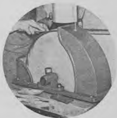
Fig. 1850. Elektrisk drevet, roterende sandsten. Den runde beholder over stenen fyldes med vand, der under slibningen løber langsomt ned over stenen, som er næsten helt indkapslet, således at den praktisk talt ikke stænker under slibningen. I bunden af skærmen er anbragt en aftapningshane, således at det vand, der efterhånden samles her, kan tappes af.
