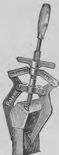
Fig. 1674. Limtvinger. Spændevidde 160 mm. (CFP).
