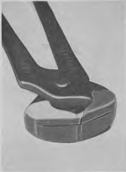
Fig. 1867. Knibtang af ny type. Kæberne er i den ene side indrettet til udtrækning af søm. De opslidsede kæber går ikke helt sammen, hvilket bevirker, at sømmet, der skal trækkes ud, ikke knibes over. (CFP).
