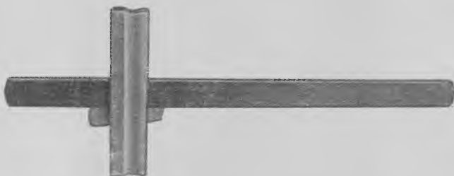
Fig. 1657. Breddemål. Hvidbøg. Med trækile. Fabrikat J. P. Bendixen. (CFP).
