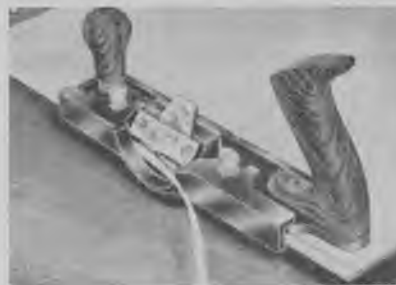
Fig. 1866 f. Record nr. 735 indstillet til affasning af hårde plader.
