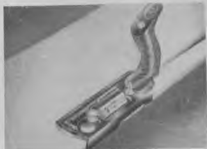
Fig. 1866 d. Record nr. 730 indstillet til gennemskæring af bløde fiberplader
