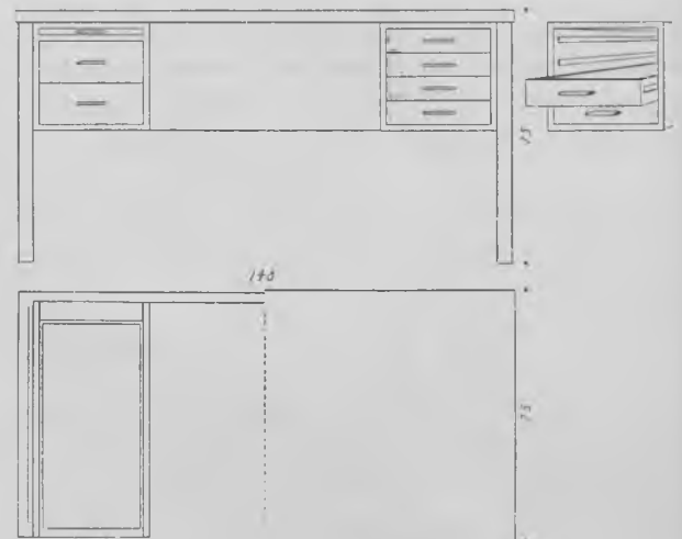
Fig. 752. Skrivebord med ophængte skabe. Mål 1:25. Skuffesiden har noter svarende til lister på skabets inderside. Systemet har samme fordel som omtalt ved fig. 751.
