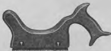
Fig. 1542. Gratsav. Med indstillelig klinge fra 6-25 mm dybde. Klingens længde 155 mm. Fabrikat J. P. Bendixen. (CFP).
