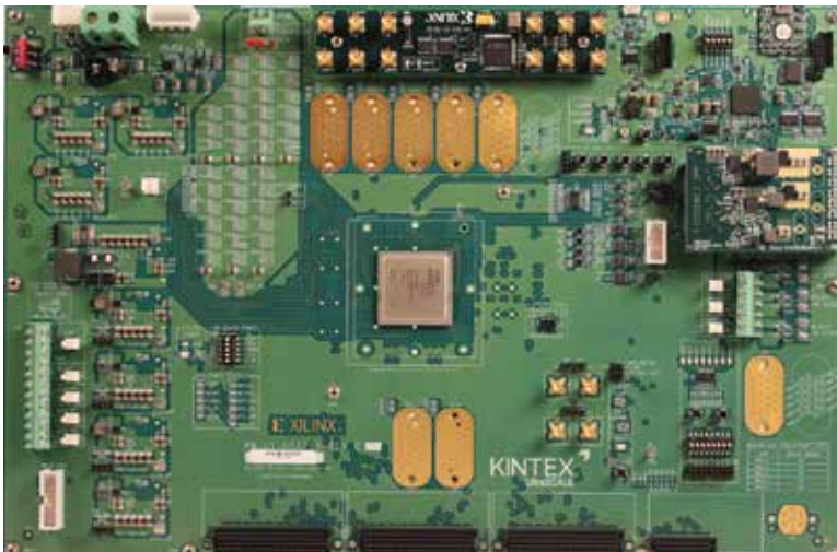
איור 3. ערכת איפיון Xilinx Kintex UltraScale FPGA KCU1250 עם 8 לוחות Bulls Eye®
