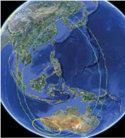
איור 6: אלומה של אחד הלוויינים על מנת להמחיש כיסוי גיאוגרפי של האלומה (FootPrint)
