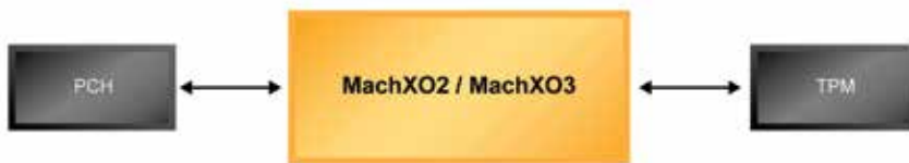
איור 8: גשר LPC אל ממשק SPI עבור TCM
