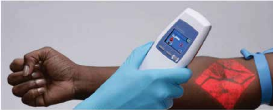
תמונה 1: סורק המציאות המרובדת הנטען, AV400, שוקל פחות מ 10 אונקיות ומציג את הוורידים מתחת לעור
