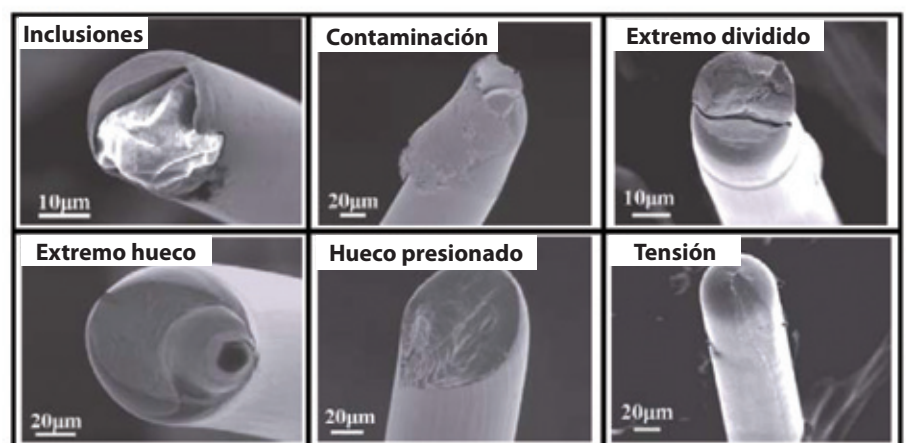
▲ Figura 1: Tipos de roturas del alambre
