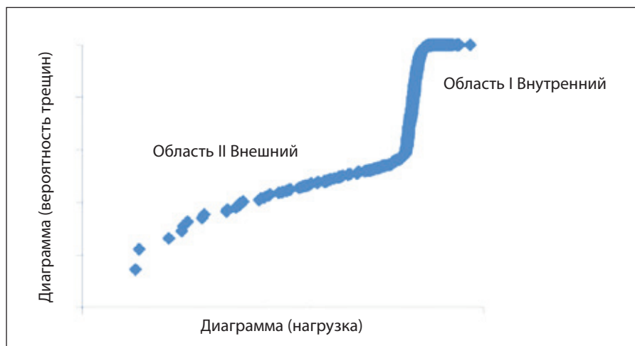
▼ Рисунок 1: Вероятность трещин на более 100 км волокна, прошедшего испытание на 10 м расчётной длины
