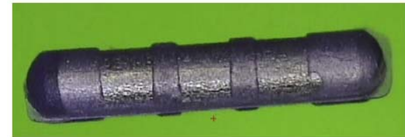
Fig. 2. Photo of an actual AnchorSeed.
