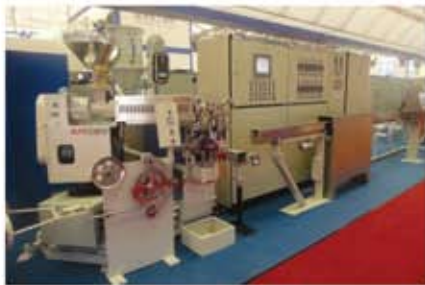
HD-Ø70mm+35mm PLC高精度數據纜串聯生產線 HD-Ø70mm+35mm PLC High precision data cable tandem extruder line 最新瑞士機型 The latest Switzerland type
