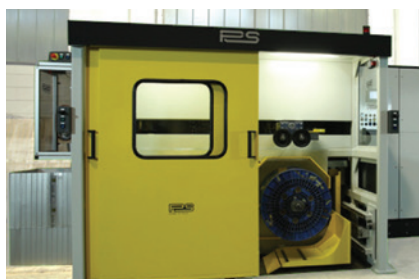
▲ The new automatic double take up from PS Costruzioni
