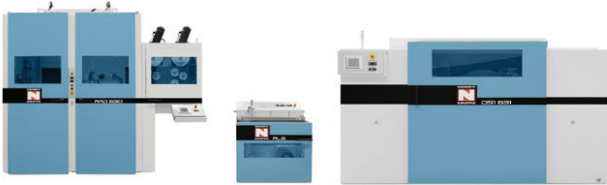
▲ Linea di trefolatura di cavi di trasmissione dati con trefolatrice a doppia torsione tipo DSI 631 combinata con uno svolgitore a detorsione a monte e uno svolgitore longitudinale a nastro
