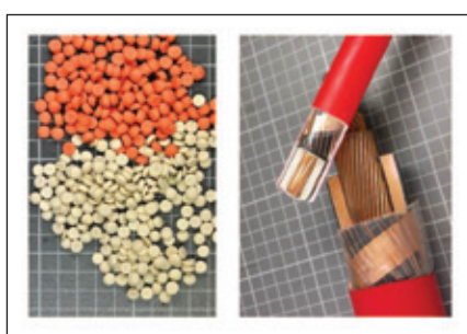
▲ Abb. 1: Bleihaltige (orange) und bleifreie (weiße) MV-Isolierung, von Pellets zu Kabeln
