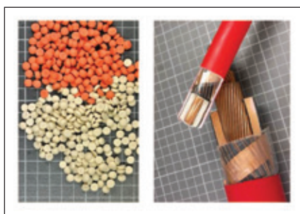
▲ Figure 1: Isolation MV contenant du plomb (orange) et sans plomb (blanc), des boulettes aux câbles
