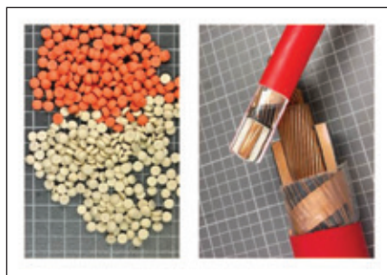
▲ Figura 1: Aislamiento de media tensión con plomo (naranja) y sin plomo (blanco), de pellets a cables
