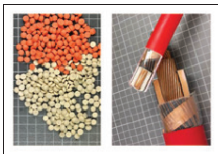
▲ Рисунок 1. Изолация для среднего напряжения, содержащая свинец (рыжая) и бессвинцовая (белая), от заготовок до кабелей
