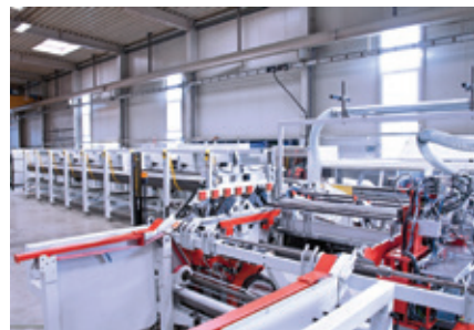
锯切、去毛刺、冲孔、成穹、压扁和卸载集中在一台机器内
