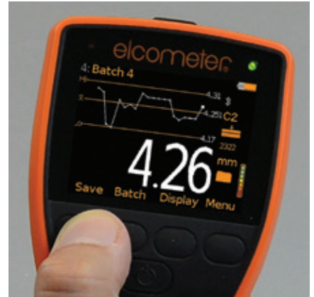
Elcometer 500的信号强度指示器防止错误的读数
