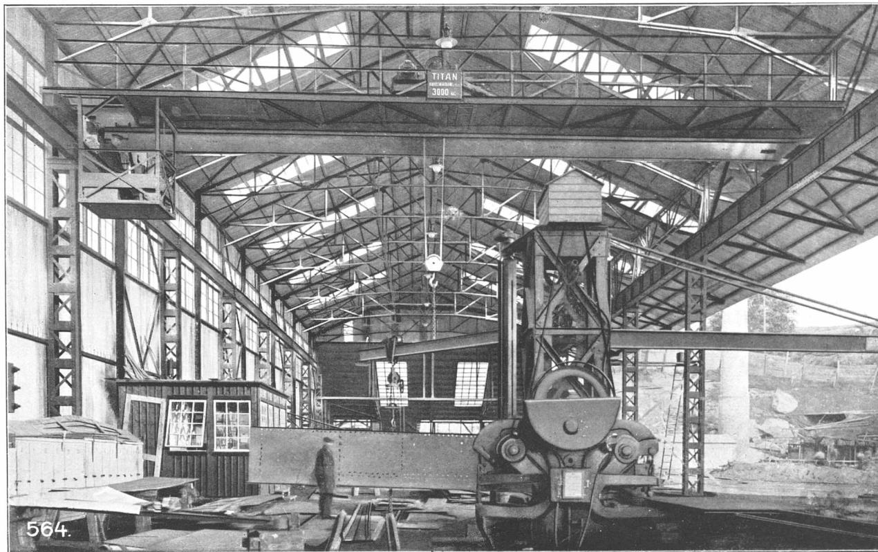
Eriksbergs mekaniska Verkstads A/B Göteborg — 3 Tons elektrisk Løbekran
