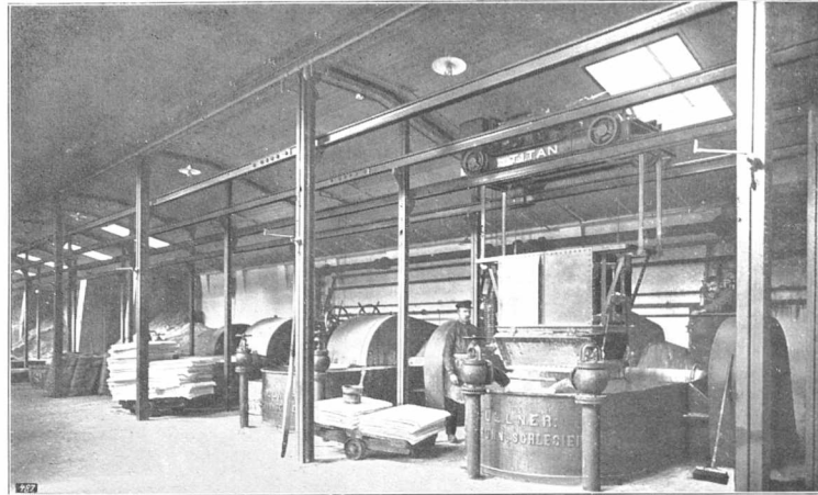
Frederiksberg Papirfabrik — Transportanlæg til Hollænder
