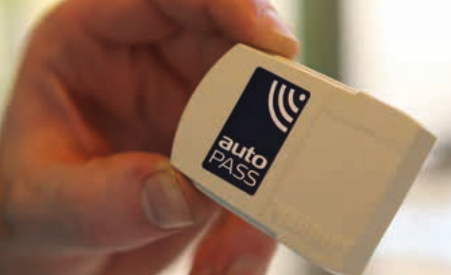
DETTE ER EN AUTOPASS BRIKKE som monteres i bilen. Hver gang bilen kjører gjennom en automatisk bomstasjon, blir den registrert elektronisk.
