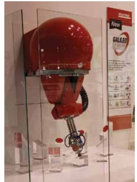
« מידול דינמי מיושם על ה-Galileo (GSR-L) Sphere Robot Light בעל 5 הצירים
