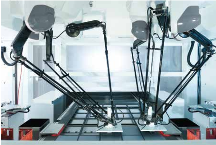
« רובוט הדלתא בעל מבנה שביר, ובמהירויות גבוהות עלול לפגוע בעצמו ובמטען שלו
