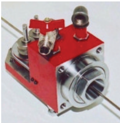
○ GPS/PDH系统进行线材重涂和线材清洁
