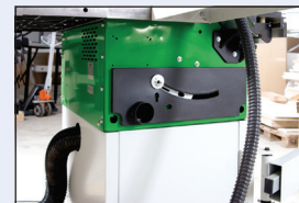
Două ajutaje laterale ( \varnothing 100 mm) pentru cuplare la unități externe de aspirație.
