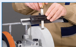
Dispozitiv pentru ascuțire în unghi, 0-30° HS.5910038
