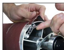
Fixarea rapidă benzii fără scule de operare.
