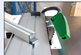
Disc de fierăstrău înclinabil de la 0° la 45°
