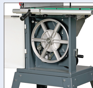
Două viteze selectabile prin re poziționarea benzii fierăstrău. Perie pentru curățarea suprafeței volanților.
