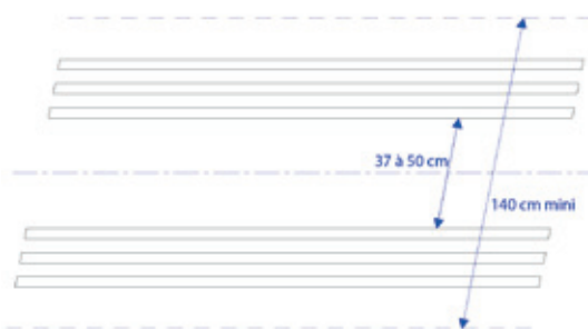
Espace entre modules de 37 à 50 cm et cheminement libre de tout obstacle sur une largeur de 140 cm minimum
