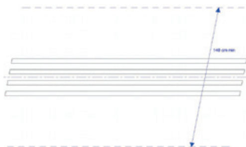
Cheminement libre de tout obstacle sur une largeur de 140 cm minimum
