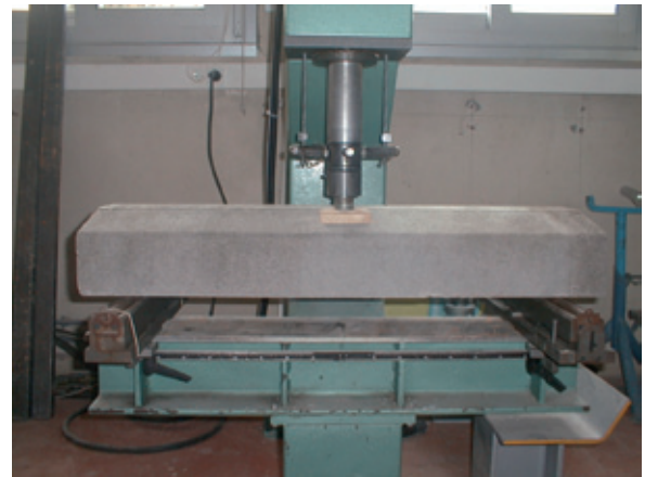
Principe de l'essai de résistance à la flexion
