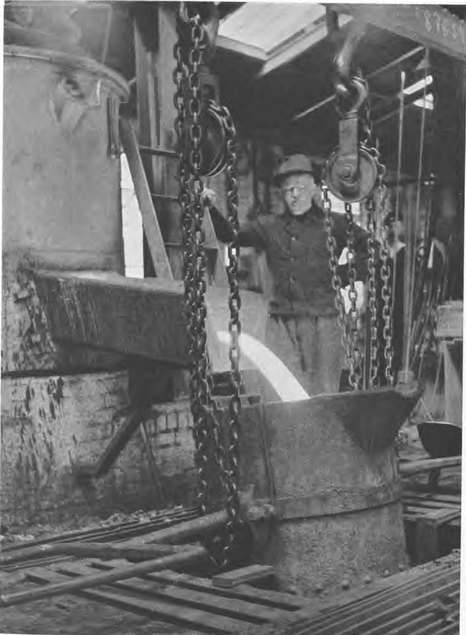
Fyldning af større Støbeske, som kan tage flere Tons flydende Jern. Manden paa Billedet er Fabrikkens nuværende Støbemester Chr. Langemark.
