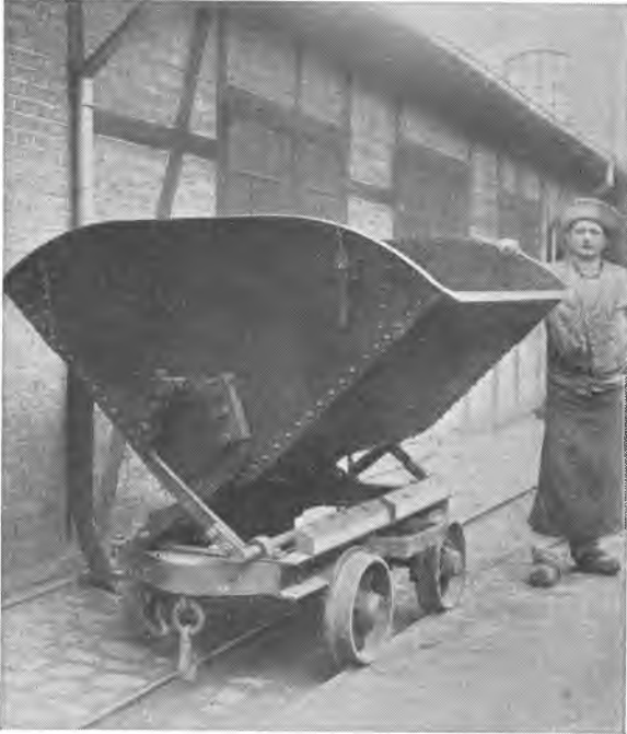
Tipvogn fra Fabrikken paa Vesterfælledvej. Marstrand & Rubow var de første, som her i Landet fremstillede Tipvogne, tildels efter egne Patenter.
