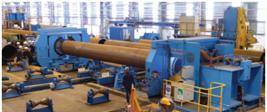
Graebener的数控管端坡口机在一台机器里同时提供机型仿形和数控仿形加工
