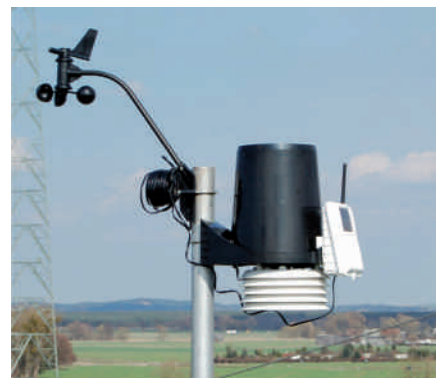
▲ Рис. 7. Автономная метеостанция с беспроводной связью
