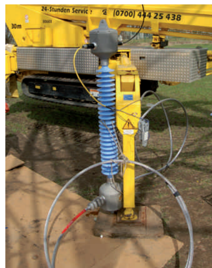
▼ Рис. 9. Разделитель в сборе перед подъемом
