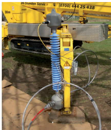
▼ Figura 9: Separatore completamente assemblato prima del sollevamento
