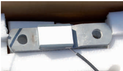
▲ Bild 5: FBG Dehnungssensor, an der Gabeltasche befestigt
