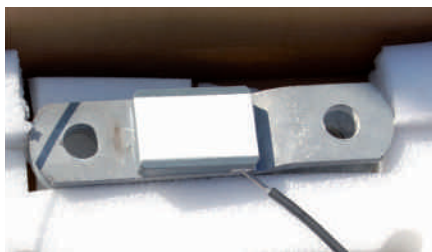
▲ Figura 5: Sensore di deformazione FBG collegato ad una piastrina di fissaggio
