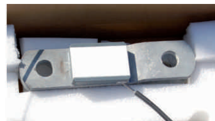
▲ Рис. 5. Тензодатчик на основе ВБР, прикрепленный к вилкообразной стыковой накладке
