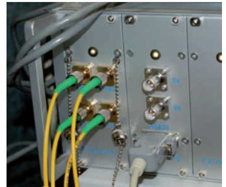
▼ Figure 10: Sommet séparateur – détails des entrées des câbles
