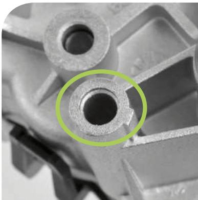
1 - Der Ersatzmotor hat kein Gewinde im Durchgangsloch.
