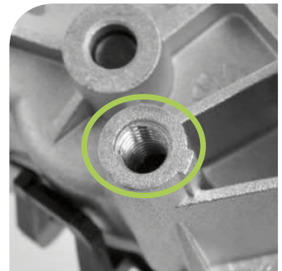
3 - Das Gewinde wird durch die Schraube geformt. (Achtung: angezogene Schraube nicht mehr entfernen! Ansonsten kann der Motor nicht erneut fixiert werden.)
