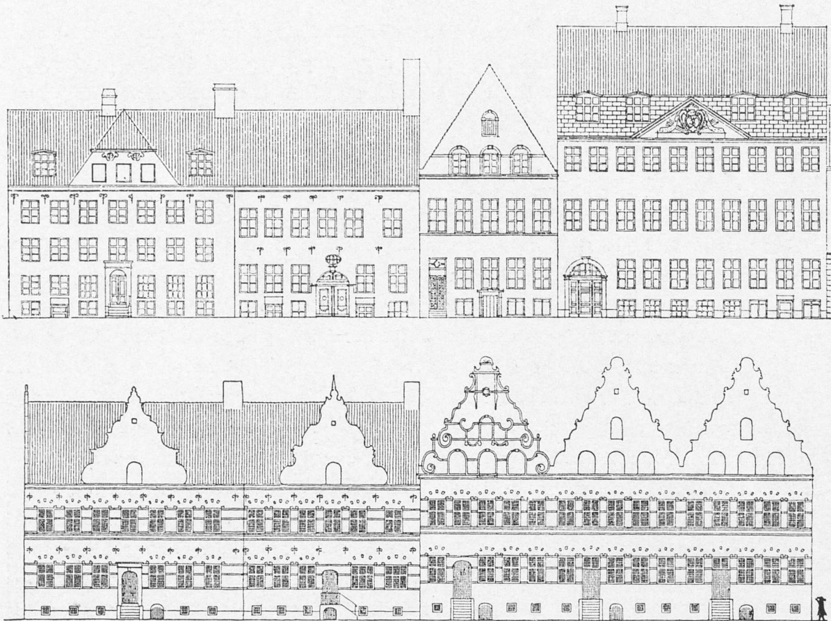
Strandgade Nr. 32—36. Foroven Husenes Tilstand o. 1940, fornedes Rekonstruktion af deres oprindelige Udseende o. 1640. Opmaalinger af H. H. Engquist.
