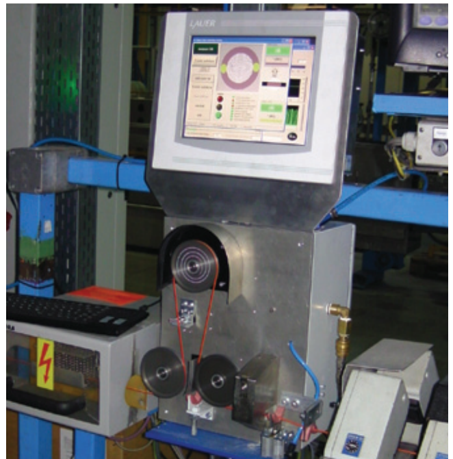
○ 图10: 在用户端测试Siebe色彩检测系统的原型，被安装在火花测试和相机之间。IPC在顶部，下端，转动机械系统和感应器(有轻薄遮盖物)
