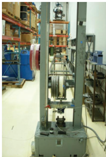
▼ Figura 4: Dispositivo di prova di trazione per misuratore longitudinale FOTP-33
