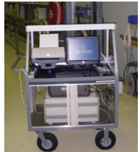
▲ Figure 5: Système de mesure avec jauge de déformation de la fibre optique
