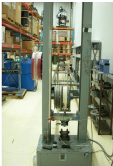
▼ Figura 4: Dispositivo de prueba de tracción para medidor de longitudes largas FOTP-33
