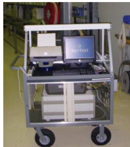
▲ Figura 5: Sistema di misura con misuratore di deformazione della fibra ottica
