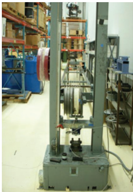
▼ Figure 4: Dispositif d'essai de traction pour jauge longitudinale FOTP-33
