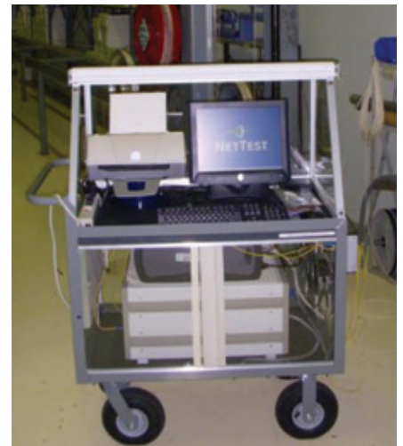
▲ Bild 5: Messsystem mit Lichtwellenleiter-Dehnungslehre
