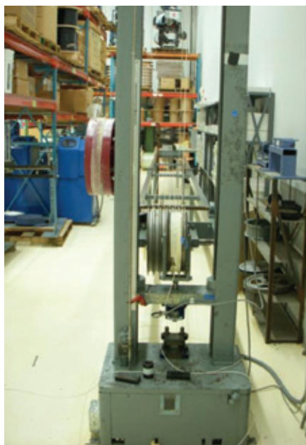
▼ Bild 4: FOTP-33 Zugprüfungsrichtungen für Längsmesser
