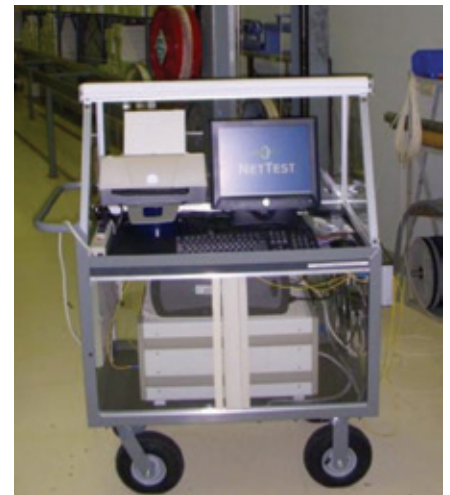
▲ Цифра 5. Система измерения нагрузки оптоволоконна
