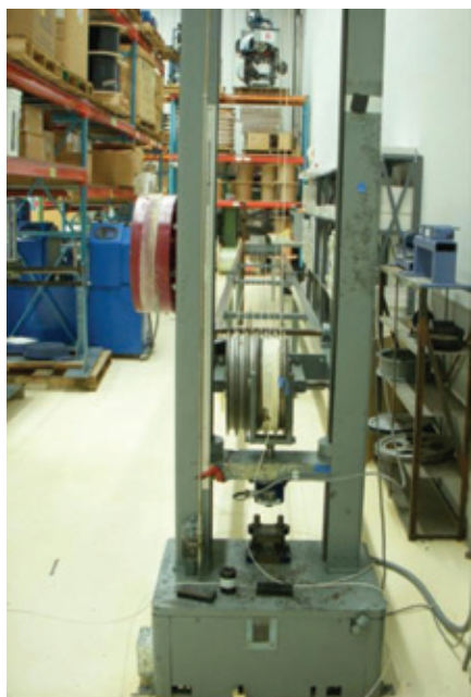
▼ Цифра 4. Становка для испытаний эластичности длины FOTP-33
