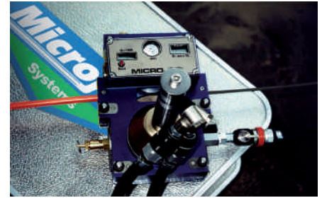
▲ Figura 12: Soffiatura del microcavo
