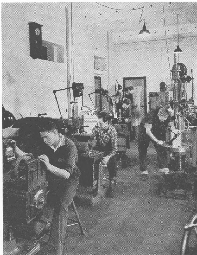
ET UDSNIT AF VÆRKSTEDET MED SHAPINGMASKINER OG FRÆSEMASKINER SAMT EN BOREMASKINE
