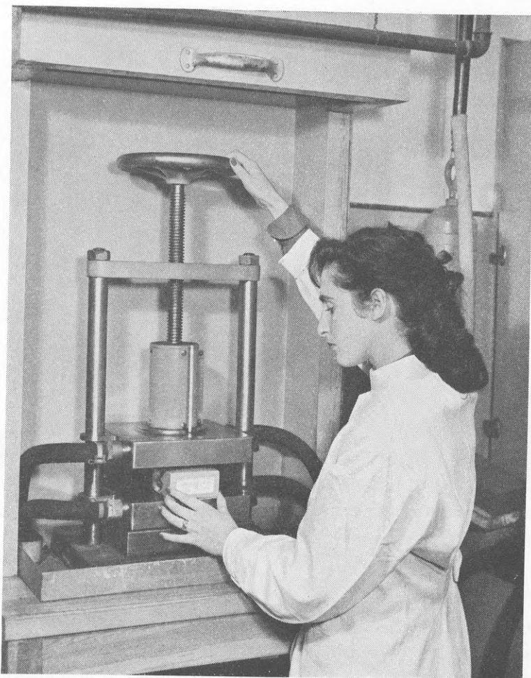
FORSØGSAPPARAT TIL BESTEMMELSE AF FRYSEHASTIGHEDEN M. M. VED KONTAKTFRYSNING
