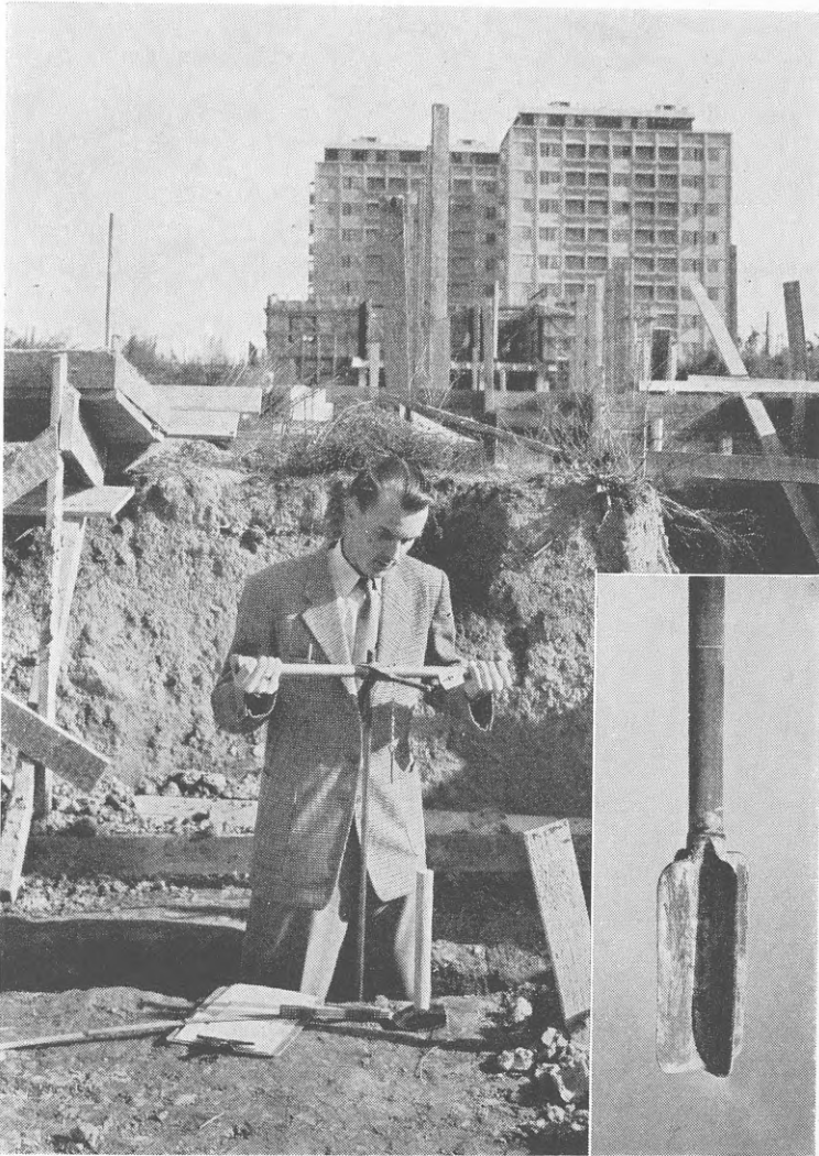
VED DREJNING AF VINGEBORET I JORDEN (SE DETAILLE AF BORET FORNEDEN TIL HØJRE) MÅLES BYGGEGRUNDENS BÆREEVNE
