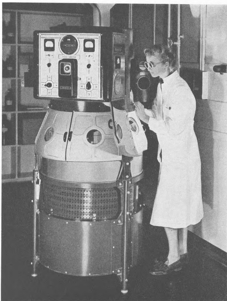
BESTEMMELSE AF LYSÆGTHED MED FADE-OMETER
