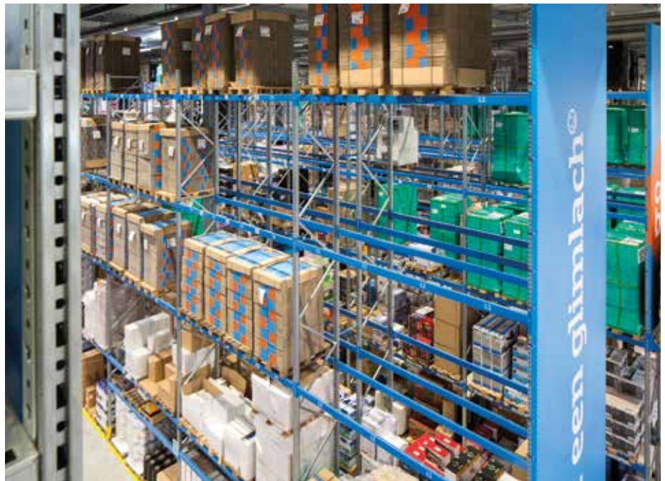
Het nieuwe magazijn telt 25.000 palletplaatsen, 22 laad- en loskades en stelt een honderdtal mensen tewerk. Grote aantallen witgoed en ander groot elektromateriaal worden op grondlocaties neergezet, kleinere aantallen gaan in rekken.
