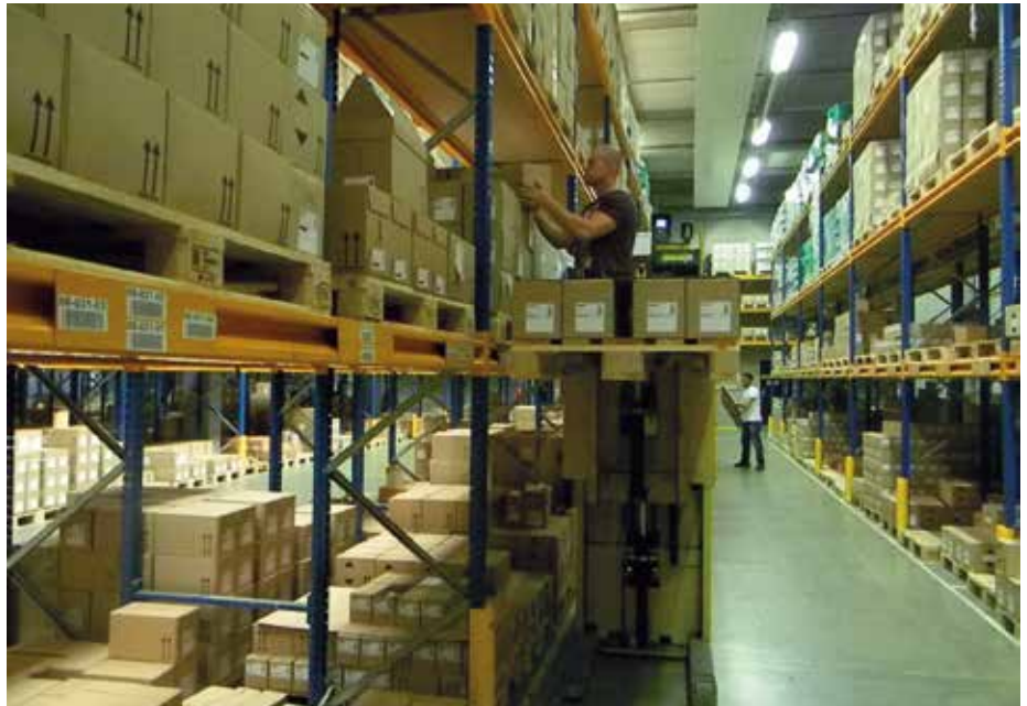
Aangezien een stapelmatrix binnen Load Building rekening houdt met de stapelrestricties, krijgen de medewerkers eerst de opdracht om de zwaarste goederen te picken en pas aan het einde de lichte goederen.
