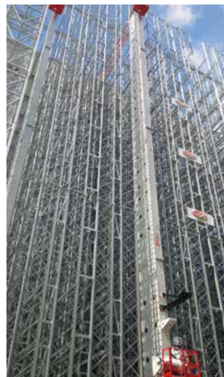
De vijf 39 meter hoge kranen zullen instaan voor de opslag en de uitslag van de pallets, goed voor een capaciteit van 65 pallets in en 70 pallets uit per uur.
