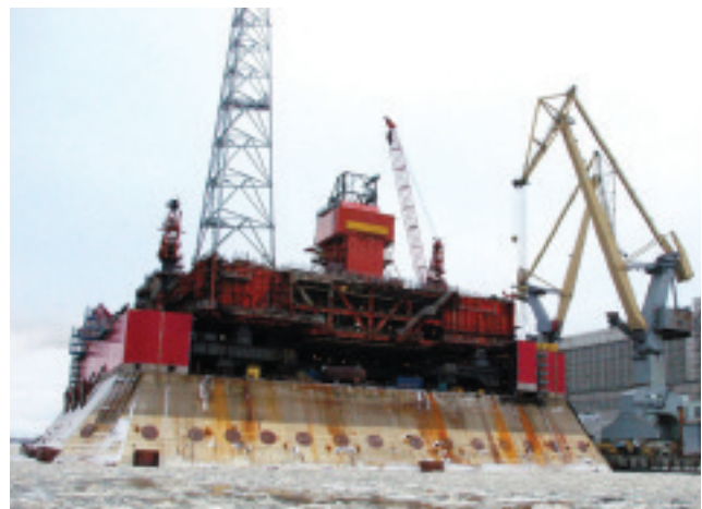
▲ La piattaforma Prirazlomnaya avrà una capacità di 22.000 tonnellate di petrolio e 1 milione di metri cubi di gas il giorno
