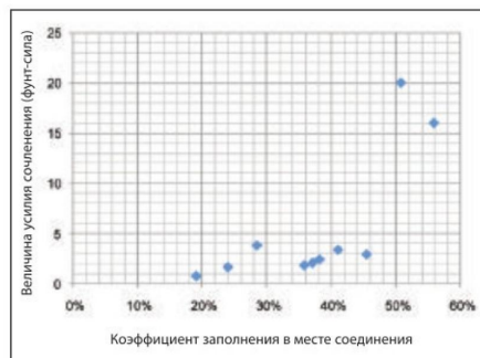
▲ Рис. 11. График зависимости коэффициента заполнения в месте соединения и величины усилия сочленения
