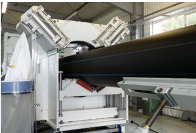
cutStream PTA 1200切割刀具可无屑切割或有屑切割，具体取决于应用（图片来源：© TehnoWorld）
