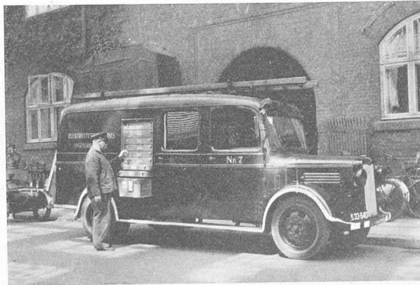
Udrykningsvogn. I Siden Skuffer til Værktøj m. m.
