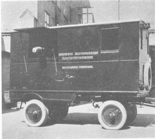
Højspændingsprøvevogn (150 kV). Prøvespændingen faas fra Isolatoren paa Siden af Vognen. Under Kørslen trækkes Isolatoren ind.
