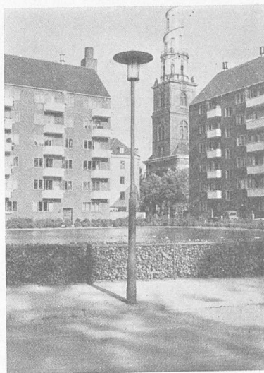
4 m Lysmast med særligt Armatur (tegnet af Poul Henningsen 1921).
