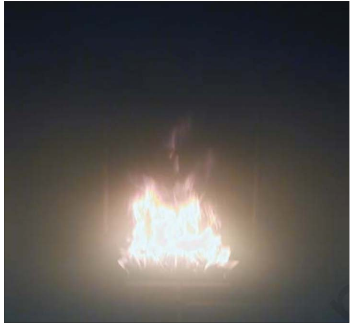
La visibilité est nulle dans cette chambre à combustion, car elle est remplie de fumée.
