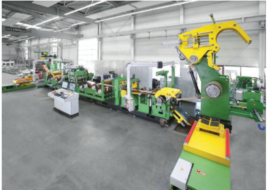
▲ Система подачи без ручной подачи, которая была разработана компанией B+S, облегчает эксплуатацию и обеспечивает экономичную эффективность линии. Начало пластины зажимается прижимной планкой в начале линии и протягивается к подаче. Это означает, что пробной пластины не требуется, и нет необходимости в сварке или направляющих планок. Намотка на разматыватель также осуществляется автоматически
