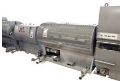
▲ Cableadora SZ de RosendahlNextrom
