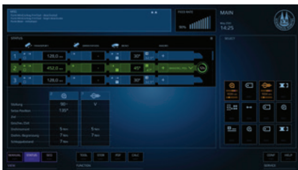
新型NxG2.0控制器除了弯曲组件的标准统计，还可以收集和评估过程数据
