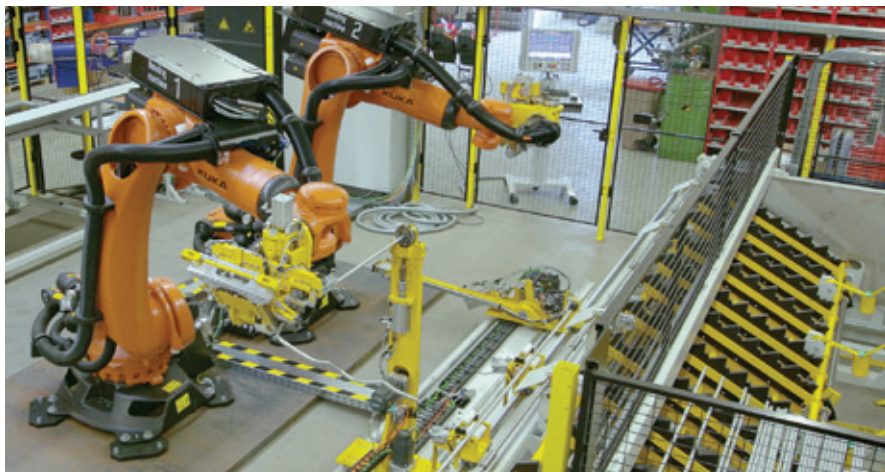
管道弯曲系统和机器人搬运的结合能够处理长度达4500毫米的管道。
