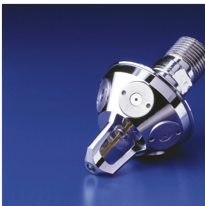
De speciella munstyckena ringar snabbt in brandhärden och förhindrar att elden sprids. Vattentrycket är drygt 100 bar och droppstorleken 10-50 \mu .
