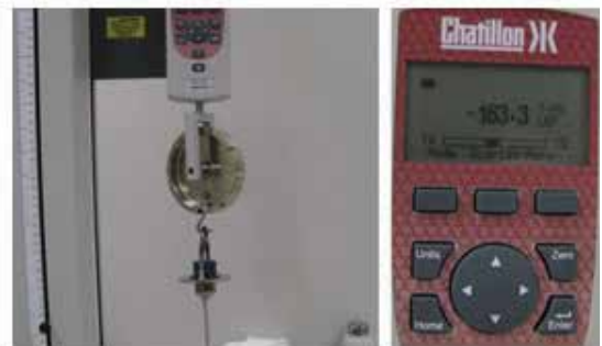
תמונה מס 2: תוצאות בדיקת משיכה, גודל מחבר משולב בהשוואה למחבר רגיל בתוספת Backshell, Integrated Flower Backshell של חברת Filconn
