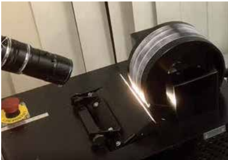
תמונה 3: מדגים לניתוח וסיווג פגמים על משטחים מתכתיים ע"י רשתות CNN מיושם באמצעות Visual Applets. מקור: Silicon Software GmbH
