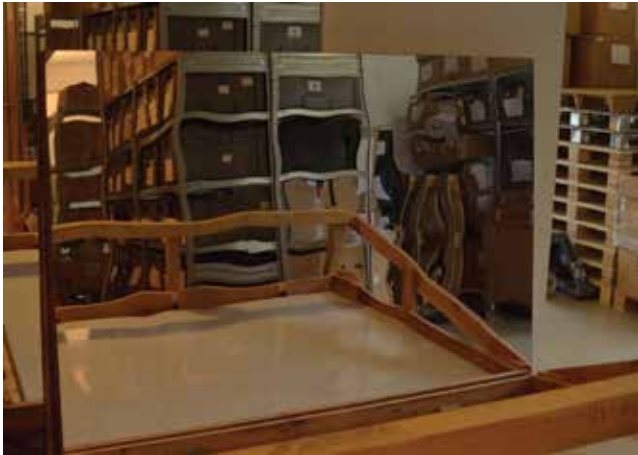
▲ איור 6: התוצאה הסופית היא הליוסטוסט בעל עלות-תועלת גבוהה שניתן לייצר באמצעות משאבים נגישים בקלות.
