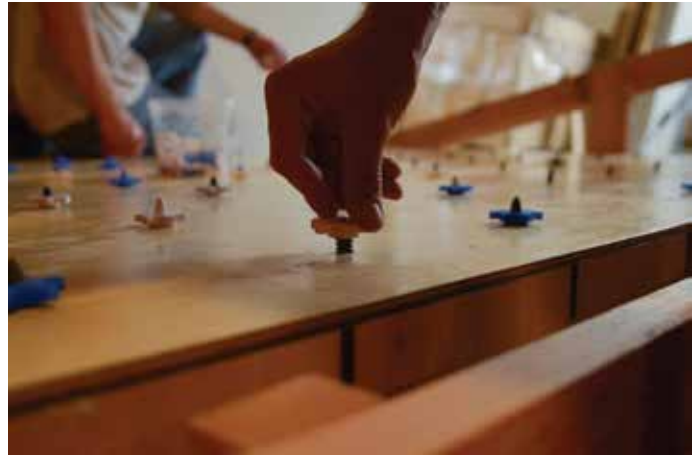
▲ איור 5: ניסוי על מנת לאתר את מידת המתח הנכונה שיש ליישם על הפינים של ההרכבה. על ידי הידוק הברגים המראה מוחדרת לצורה הקעורה של מסגרת העץ.
