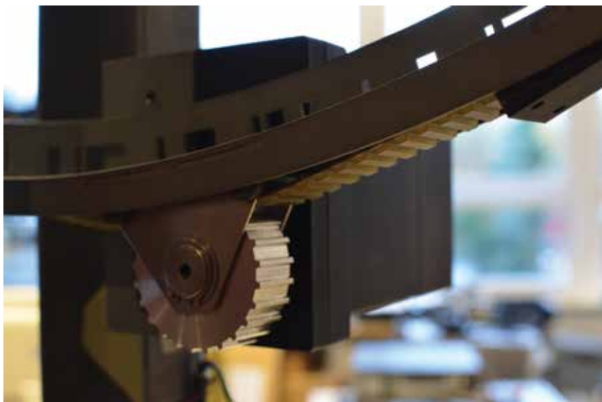
איור 2: סגירת מערכת ההנעה והחישוק המורכב
