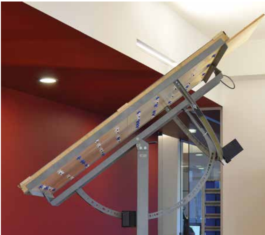
איור 4: הרכבת המבנה דמוי הסנדוויץ'. על ידי הידוק הברגים, המראה מוחדרת לצורה הקעורה במסגרת העץ.
