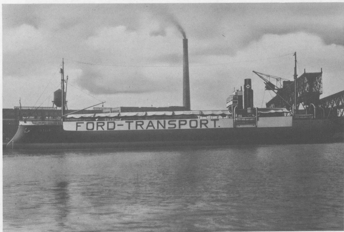
Til Transport af Automobiler havde Fordfabriken sikret sig en Række Skibe, specielt indrettet hertil. Billedet viser m/s „Ægir“, som havde Plads til 350 Automobiler. Lignende Skibe var m/s „Odin“ - Kapacitet 220 Automobiler - og m/s „Charlotte“ - Kapacitet 70 Automobiler -.
