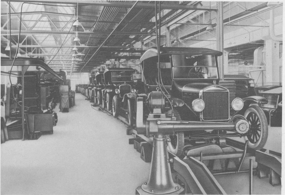
Det 100 m lange Transportbaand i Monteringshallen
