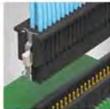
נעילה בטוחה נעילות אותן יש להפעיל ביד מגדילות את חוזק ההיצמדות במידה של עד 200%
