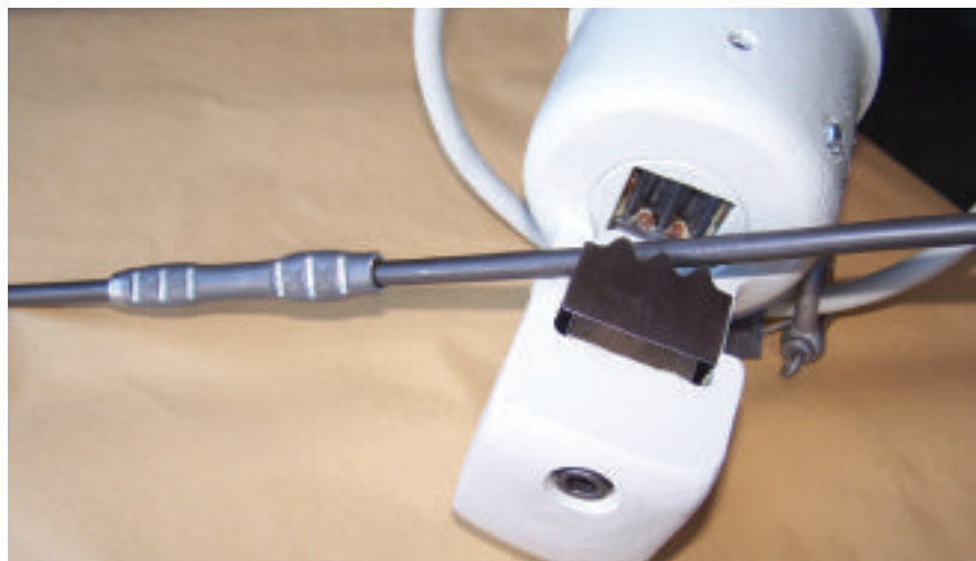
○ Petig生产的液压卷边钳，用于线缆对接
