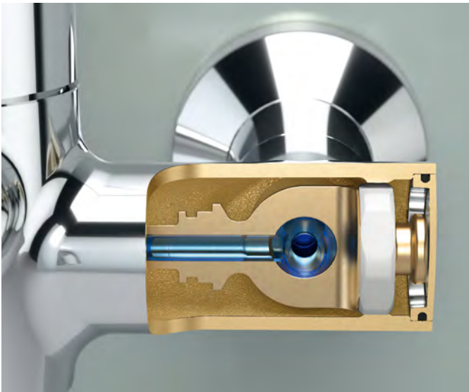
Reduzierte Durchmesser erhöhen die Fließgeschwindigkeit und verringern das Stagnationswasser auf 66 \text{ cm}^3 .
