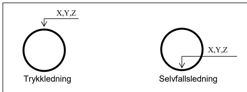
Måling av ledningshøyde.
