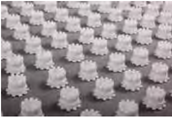
« איור 2. 201,600 חלקים עבור חברת GI View. השימוש בטכנולוגיית SLS.
