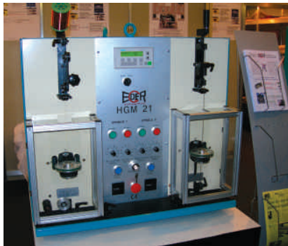
○ HGM-21 - 高速线材型ND/PCD模具定径/抛光机
