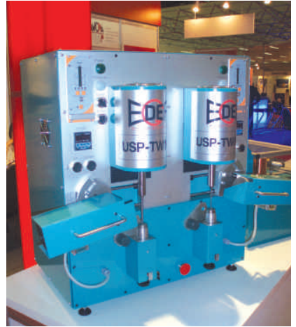
○ USP-TWIN - 双工作台超声波ND/PCD模具加工机
