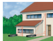
ESTIMAR ALTURAS: calcular alturas con 2 o 3 puntos ESTIMAR ALTURAS: estimar alturas com 2 ou 3 pontos
