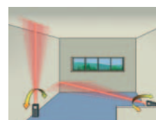
FUNCIÓN DE REPLANTEO DE DISTANCIAS CONSTANTES: Minimum or maximum distance per scanning FUNÇÃO DE REMODELAÇÃO DE DISTÂNCIAS CONSTANTES: distância mínima ou máxima por medição
