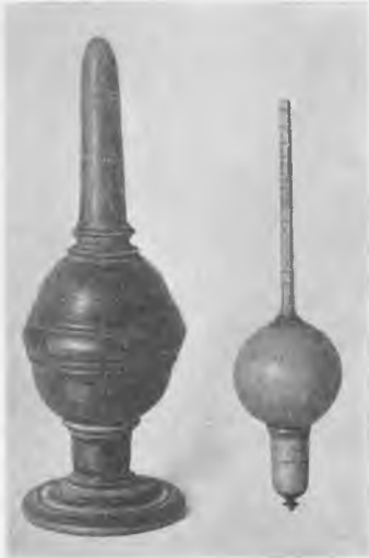
Brændevinsprøver af Elfenben med Inddeling i 12 Grader og tilhørende drejet Etui af Træ, 18. Aarh. Fra et Brænderi i Nørresundby. „Den gamle By“.
